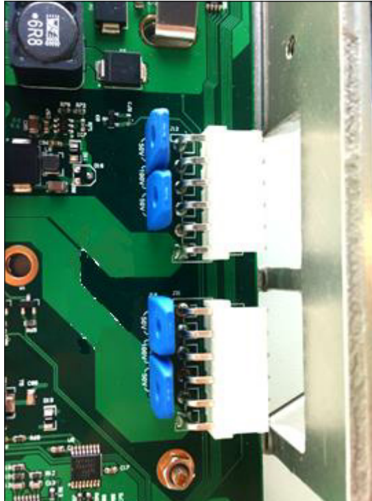
Jumper-Einstellung 50 V pro Kanal - Verstärkereinheit
